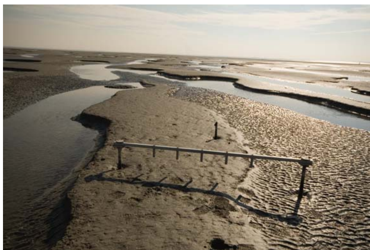
Figuur 1: Foto van een sedimentatie/erosie meetpunt
