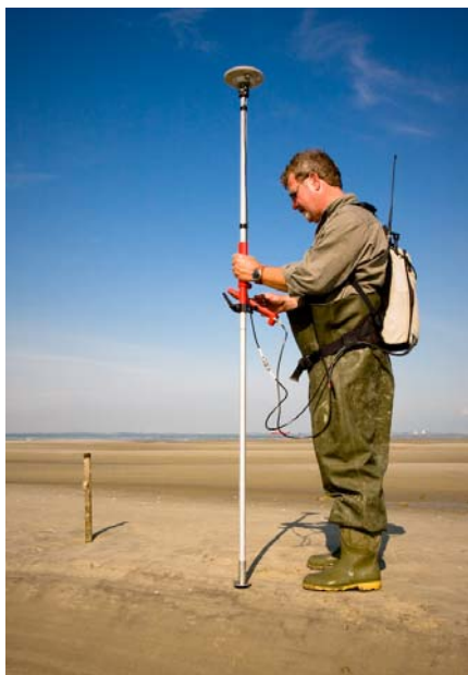
Figuur 2` : RTK meting bij een sedimentatie/erosie punt
